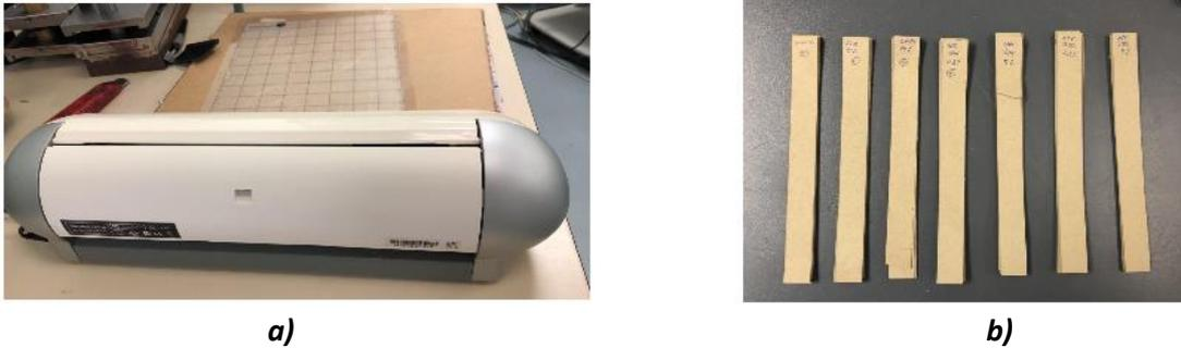
**Figura 20. (a) Plotter, equipo de corte. (b) Probetas cortadas a medida.**
