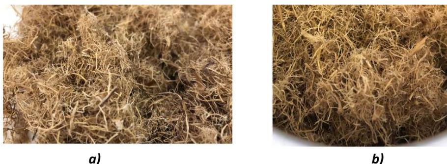
**Figura 8. Material antes (a) y después (b) del proceso de corte.**
