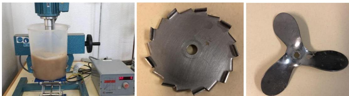
**Figura 13. (a) Homogeneización de la pasta. Tipo de discos utilizados: (a) Tipo cowles. (b) tipo hélice.**
