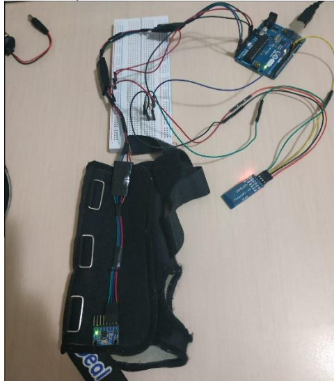
Figura 44 - Acelerômetro costurado na luva ortopédica.
