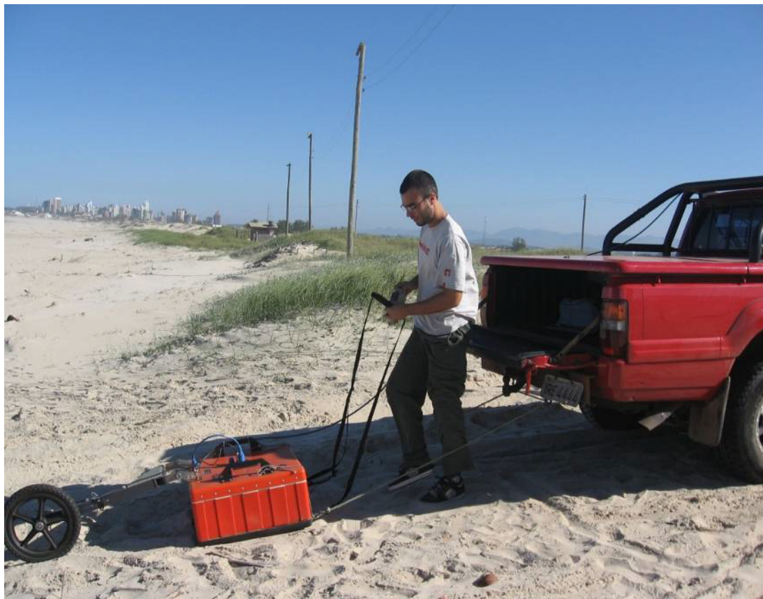
Figura 23: Antena do GPR foi fixada ao veículo para otimizar a aquisição dos dados.
