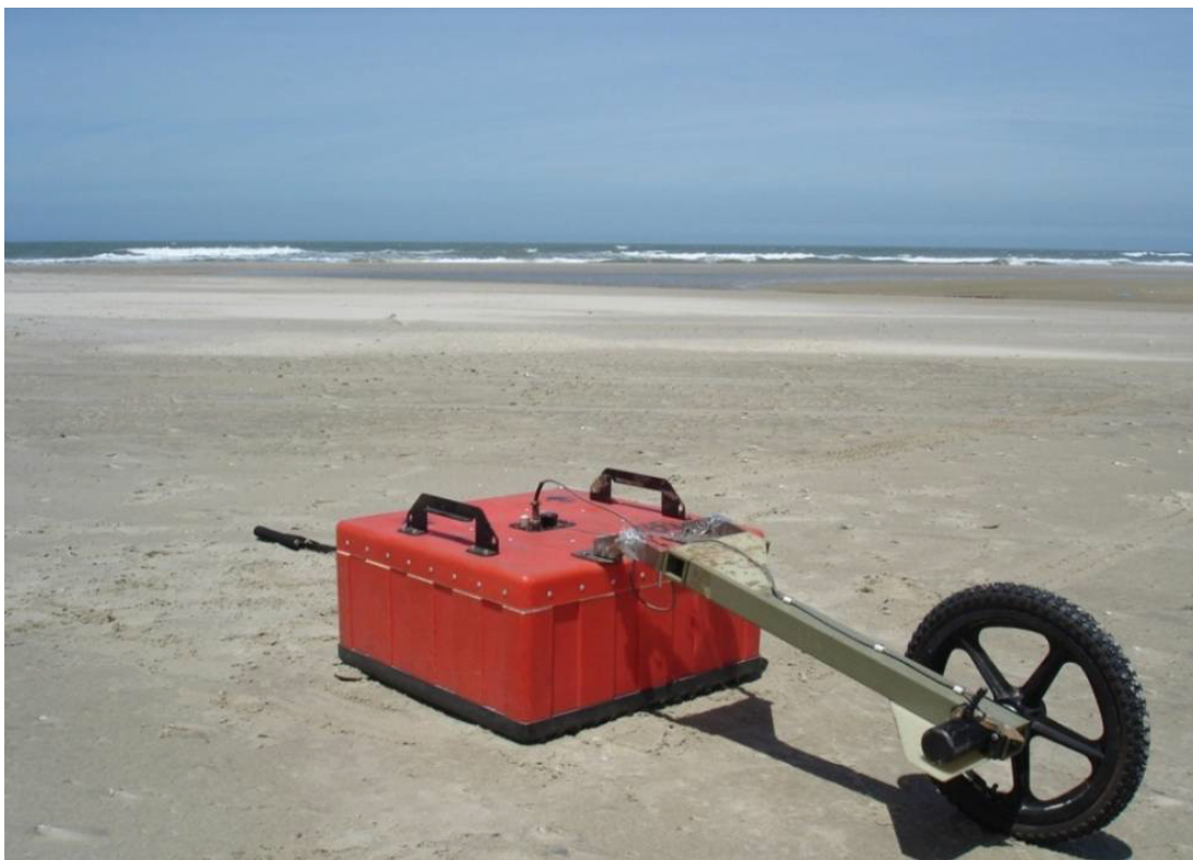
Figura 21: Antena utilizada na aquisição dos dados. Essa é composta por uma caixa blindada (vermelha) a qual possui internamente uma antena transmissora e outra receptora. O sistema de aquisição foi baseado na distância percorrida, através de um odômetro conectado a uma roda junto à caixa.
