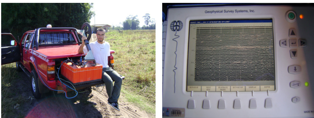
Figura 22: Durante a aquisição dos dados, a caixa com as antenas é conectada por um cabo (na fotografia à esquerda) a unidade controladora (na fotografia à direita). Nesta unidade visualizam-se os dados em tempo real.
