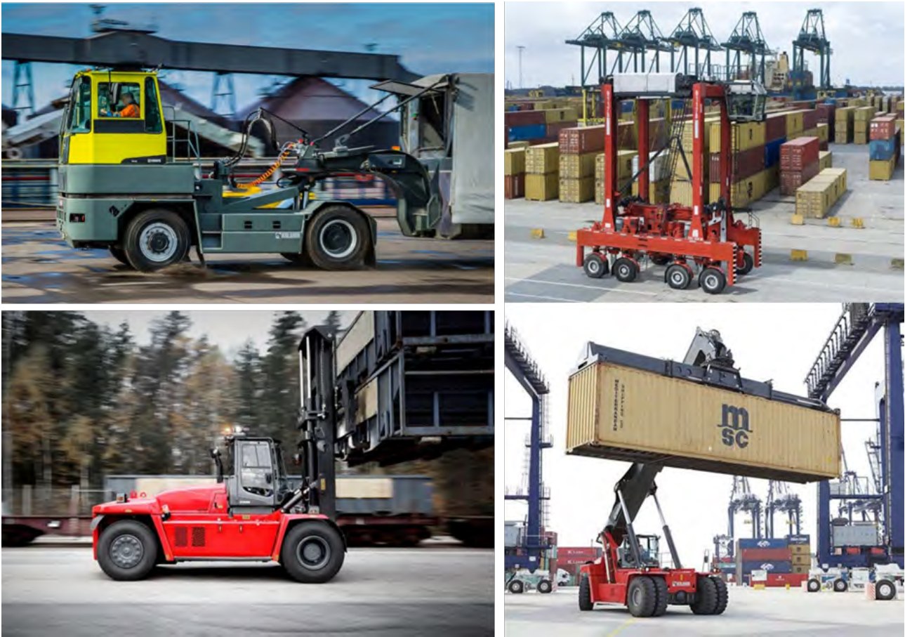
Kuva 1: Yleisimmät työkonemat Vuosaaren satama-alueella: terminaalitraktori eli nk. vetomestari (vas. ylhäällä), satamalukki (oik. ylhäällä), haarukkatrukki (vas. alhaalla) ja konttikurottaja (oik. alhaalla).
