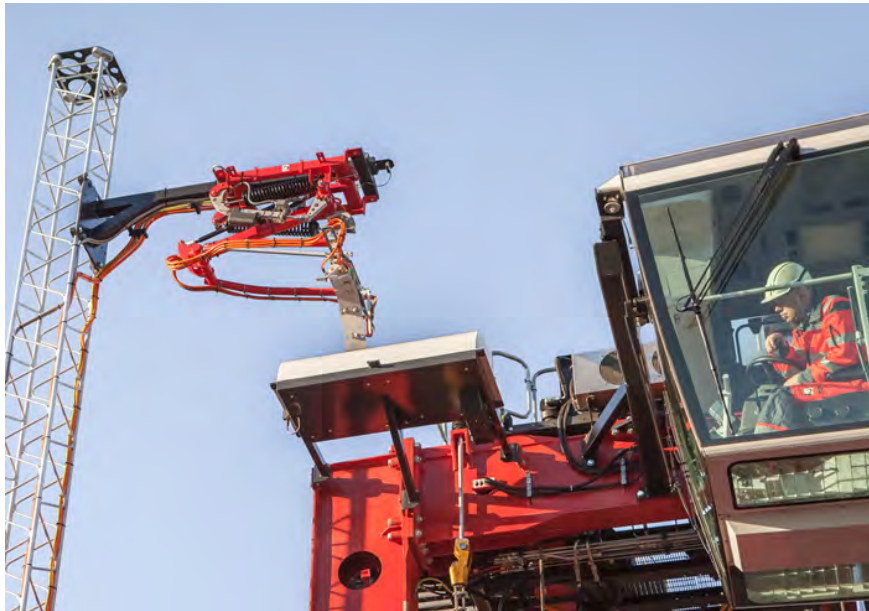
Kuva 16. Kalmarin valmistama täyssähköinen konttilukki käynnistämässä pikalatausta. Kuva: Kalmar
