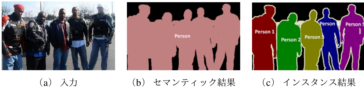
図4 セマンティックセグメンテーションとインスタンスセグメンテーションの差異
