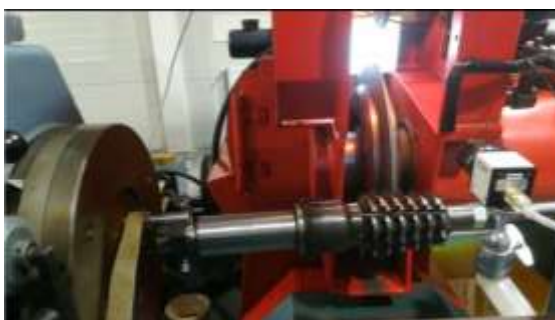
1. ábra Kúpos csigamaró tengelyelállítással történő megmunkálása a DifiCAD Mérnökirodában
