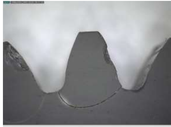
3. ábra. Kopott fogfelület, fogtörés (30x nagyítás)
