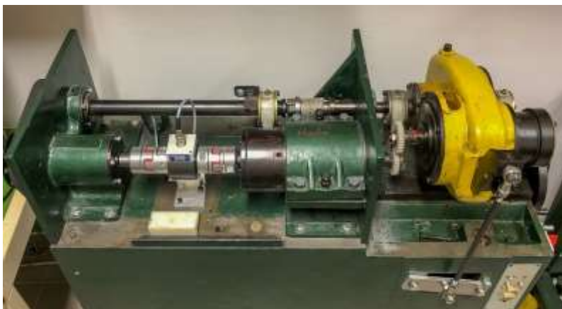
1. ábra. Hajtástásvizsgáló fékpad
