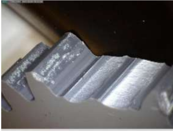
3. ábra. Kopott fogfelület, fogtörés (30x nagyítás)
