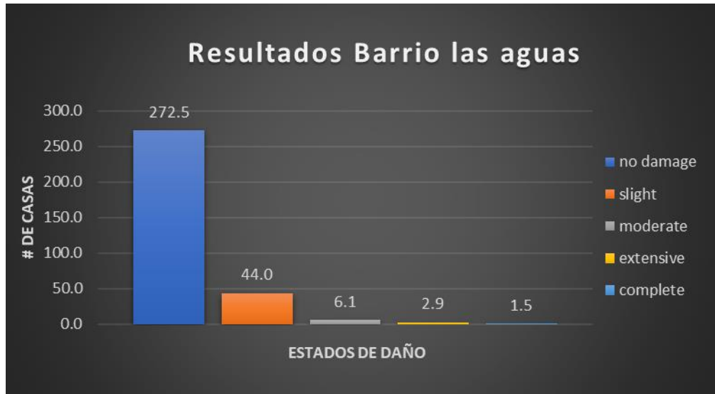
Figura 22. Número de estructuras por daño del barrio Las Aguas ante un sismo de magnitud 7,0.
