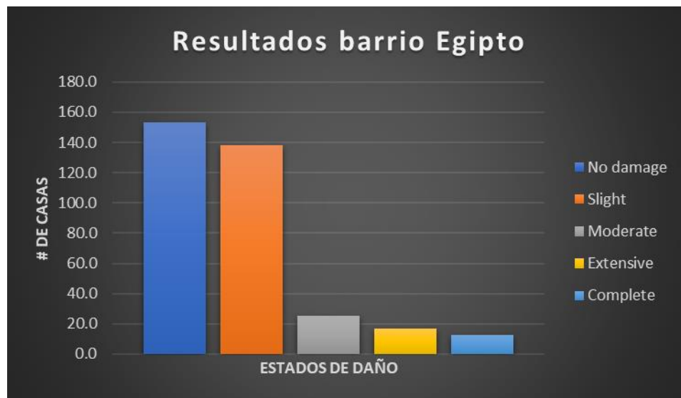
Figura 32. Número de estructuras por daño del barrio Egipto ante un sismo de magnitud 8,0.
