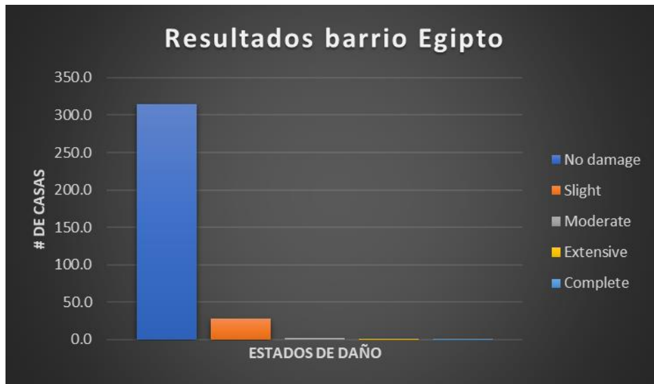
Figura 28. Número de estructuras por daño del barrio Egipto ante un sismo de magnitud 6,0.
