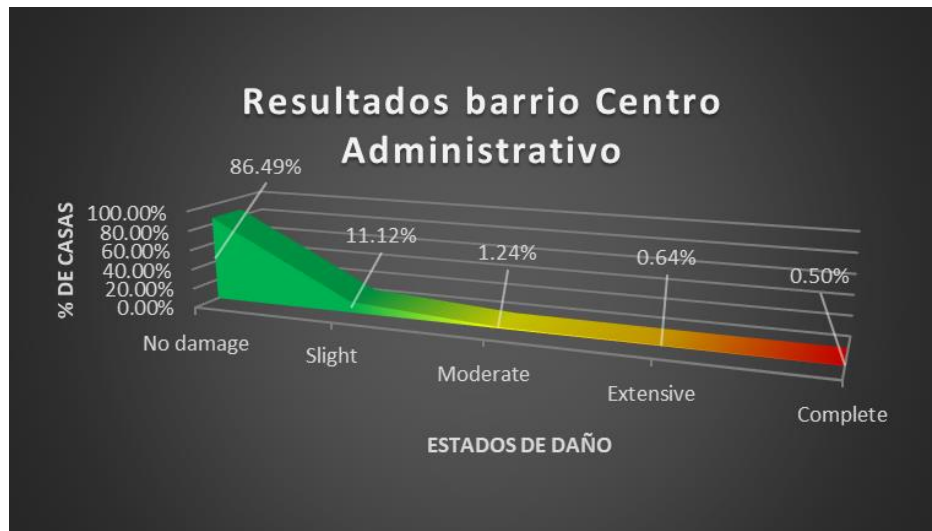
Figura 11. Fragilidad de las estructuras en porcentaje del barrio Centro Administrativo ante un sismo de magnitud 6,0.
