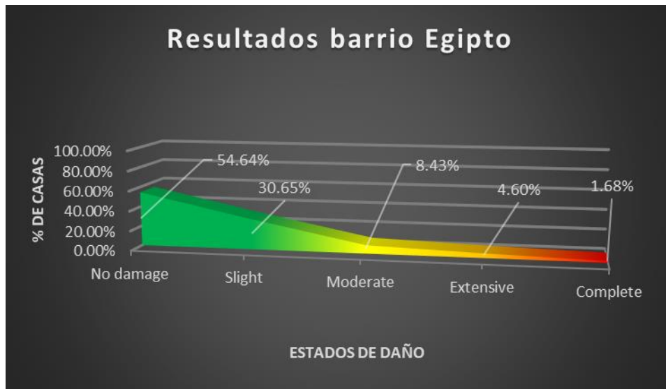
Figura 34. Fragilidad de las estructuras con concreto reforzado ante un sismo de magnitud 8,0.
