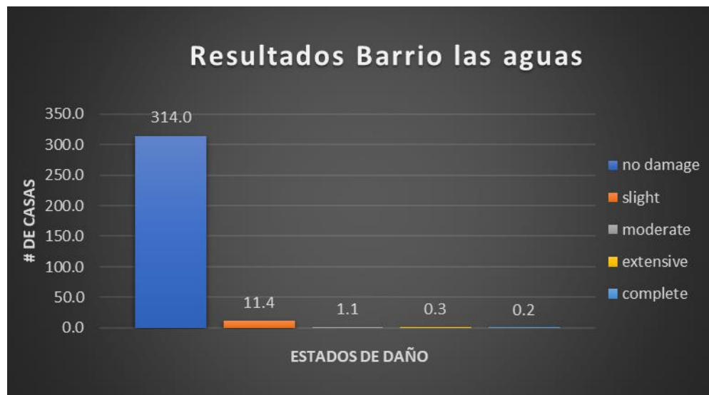
Figura 20. Número de estructuras por daño del barrio Las Aguas ante un sismo de magnitud 6,0.
