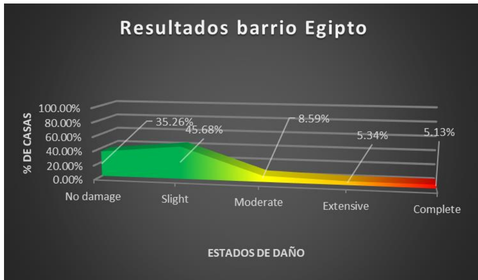
Figura 33. Fragilidad de las estructuras de mampostería con adobe ante un sismo de magnitud 8,0.
