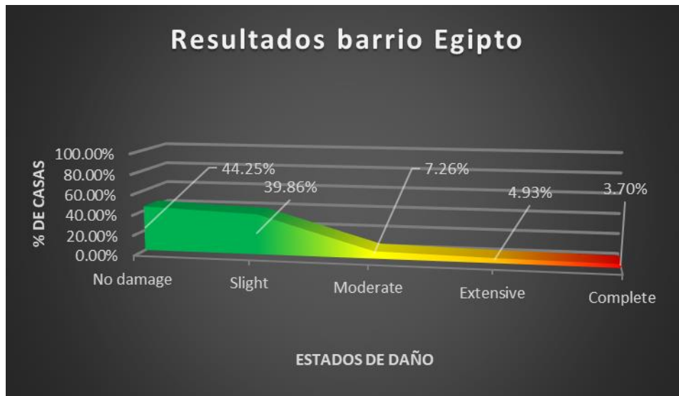
Figura 31. Fragilidad de las estructuras en porcentaje del barrio Egipto ante un sismo de magnitud 8,0.
