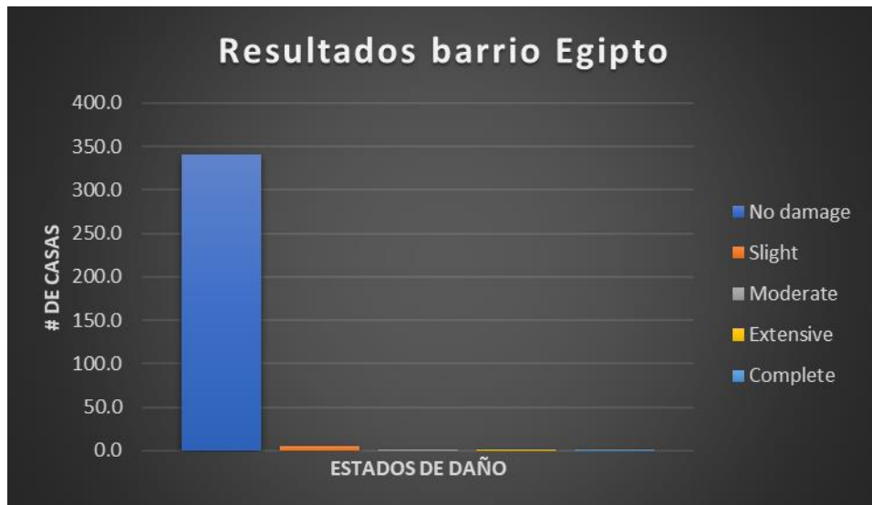
Figura 26. Número de estructuras por daño del barrio Egipto ante un sismo de magnitud 5,0.
