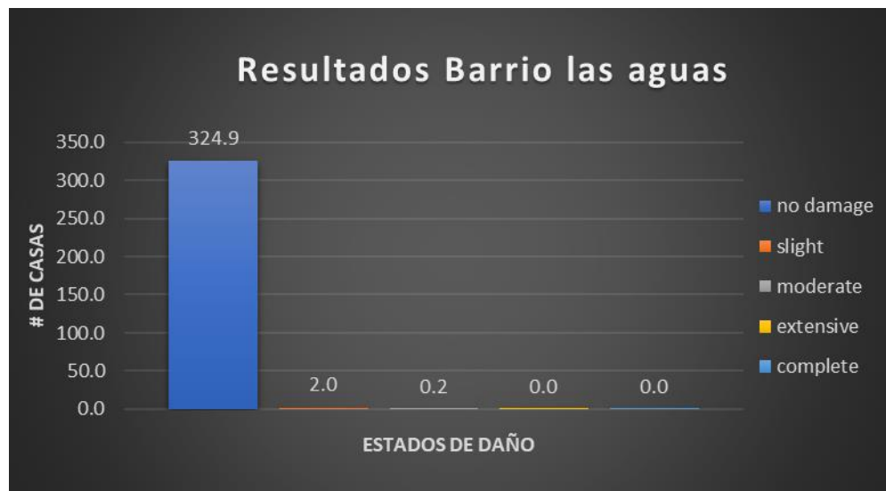
Figura 18. Número de estructuras por daño del barrio Las Aguas ante un sismo de magnitud 5,0.
