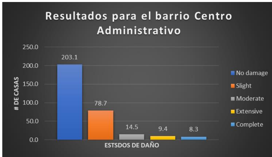
Figura 14. Número de estructuras por daño del barrio Centro Administrativo ante un sismo de magnitud 7,0.
