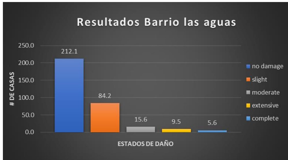
Figura 24. Número de estructuras por daño del barrio Las Aguas ante un sismo de magnitud 8,0.
