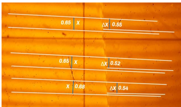
Gambar 5. Hasil pengamatan dan pengukuran ketebalan lapisan tipis TZO dengan Tolansky Apparatus.
