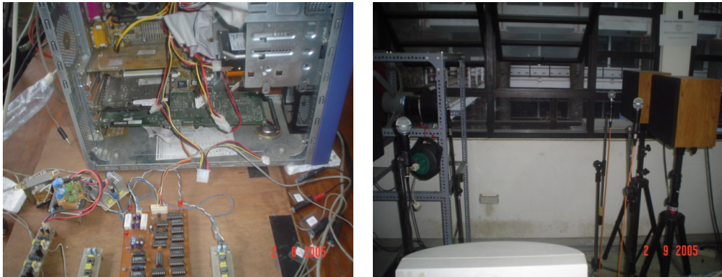
Foto 1 DSP dan antar muka (kiri), set-up eksperimen kendali bising aktif (kanan).
