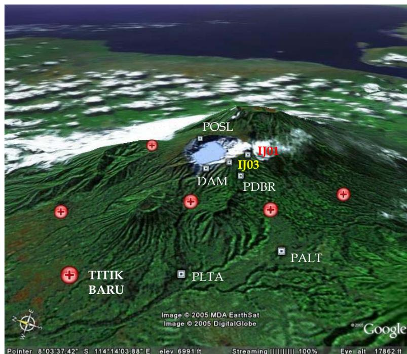
**Gambar 13** Alternatif penguatan jaring GPS di Gunung Ijen.
