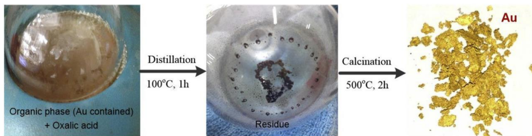
Figura 6. Proceso de refinación del oro (Au) para una recuperación con solventes orgánicos. Fuente: [19].
