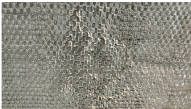
7. Craquelés an der Harzschicht, die zu einem fortlaufenden Materialverlust führen. Foto: Restaurierungszentrum Düsseldorf, Judith Bützer, Katharina Klauke.
