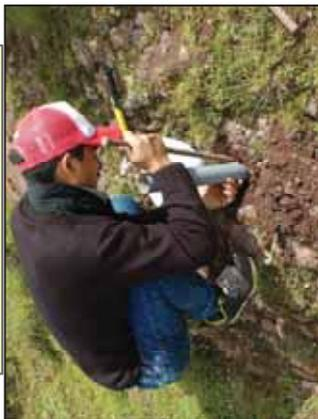
Ensayo de infiltración N° 08, que se realizó en la Formación Huancane, asiendo el uso de un tubo PVC de 2" y agua para la infiltración.
