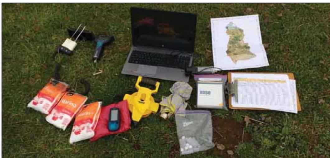
Foto 5.4. Materiales de campo para la medición de caudal.
