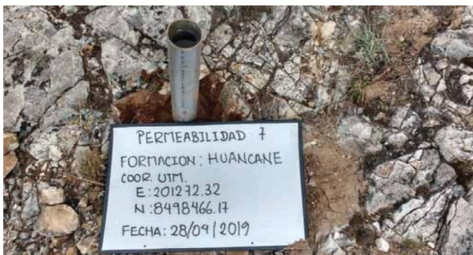
Foto 5.9. Ensayo de infiltración en la Formación Huancané, donde se pueden apreciar fracturas.
