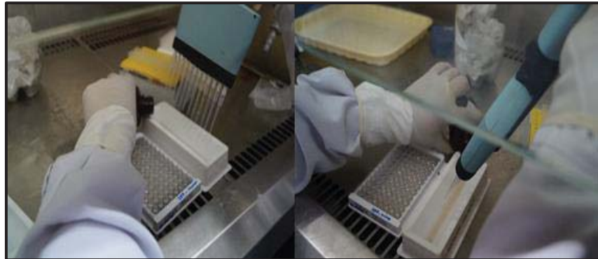
Fotografía 8. Lavado de las placas culminada la incubación de 18 horas con 300µl de solución de lavado por 5 veces.
