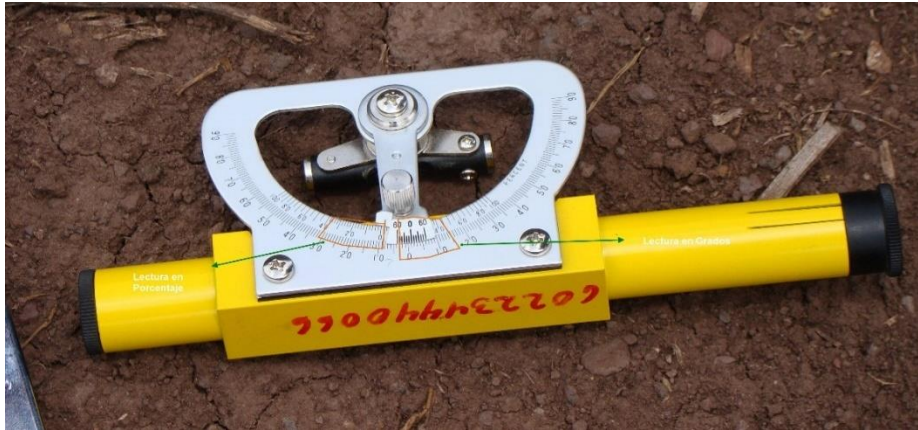
Foto: Eclímetro, este equipo mide la pendiente en grados y porcentajes.
