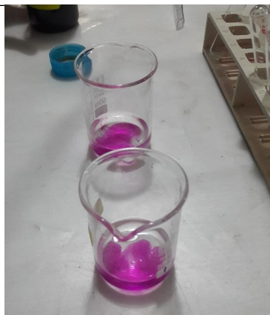
Fotografía 42. La muestra conjuntamente con los reactivos se lleva a calor hasta que este bote el primer vapor
