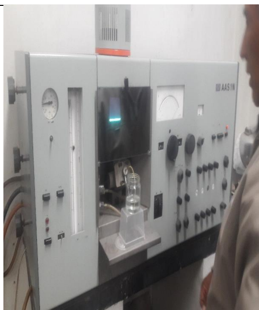
Fotografía 34. Lectura de las muestras de cobre por adsorción atómica
