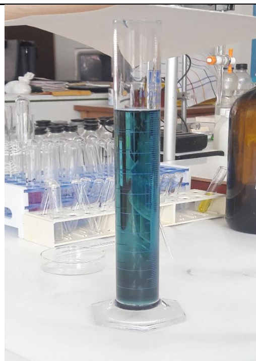
Fotografía 40. Ditizona disuelta en cloroformo al 99%
