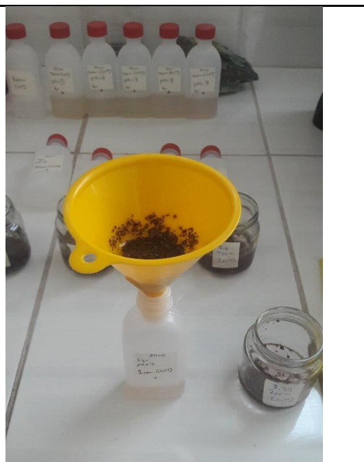
Fotografía 32. Filtración de la parte sólida de la solución bioadsorbente-soluto para lectura del cobre
