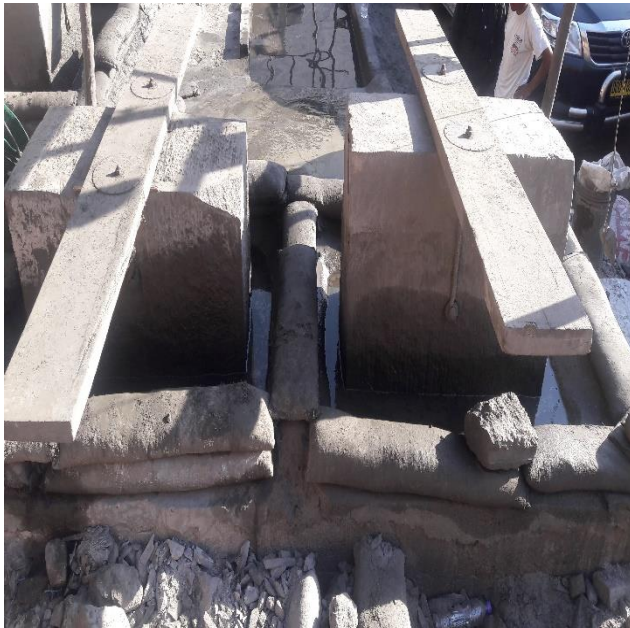
Fotografía 11. Chancadoras de piedra con oro, entrada de mercurio en el proceso
