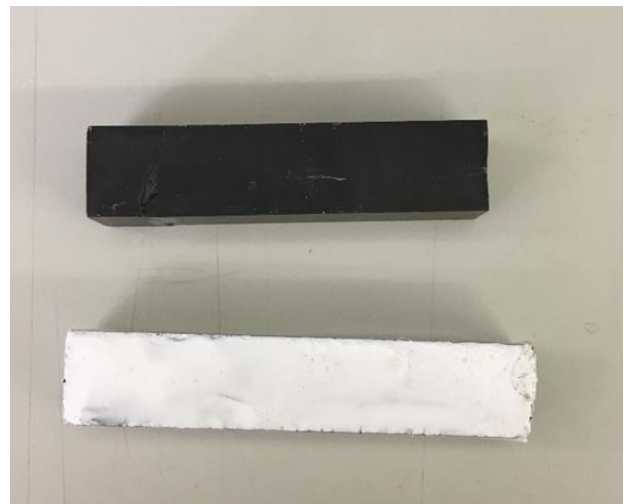
図5 接着剤を全体に塗布した材料
