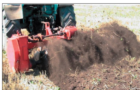
Рис. 2. Полевые испытания почвообрабатывающего агрегата с роторным плугом
