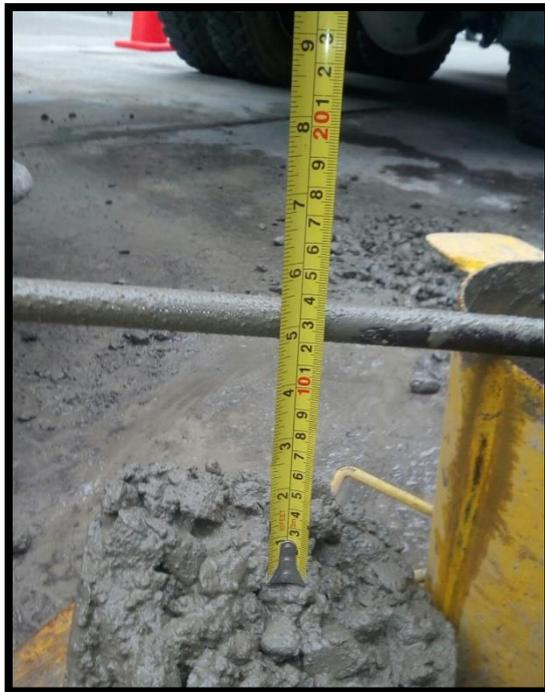
*Figura N° 44: Slump de Concreto para Placas.*
