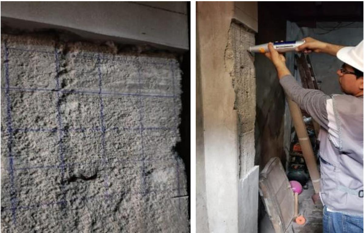
*Figura 52: Ensayo de esclerometría en columnas con grietas*
