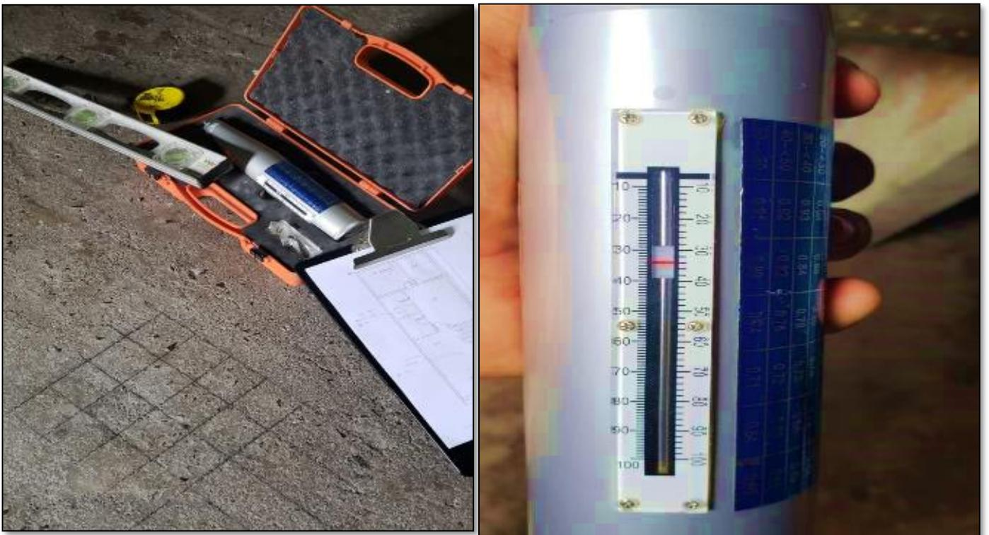
*Imagen 4: evaluación de concreto con esclerómetro losa segundo nivel*
