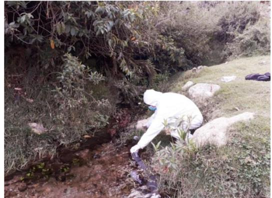
Fotografía 4. Toma de muestra de calidad del agua en la zona de captación.
