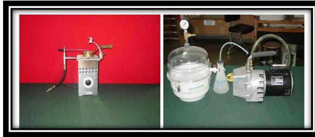
*FIGURA II-15 EQUIPO PARA PRUEBA DE PUNTO DE LLAMA Y GRAVEDAD TEÓRICA MÁXIMA.*
