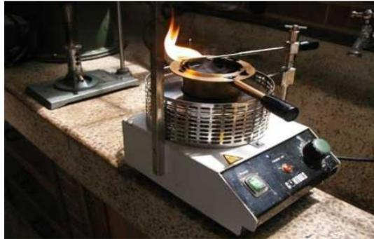
*FIGURA II-16 ENSAYO DE PUNTO DE INFLAMACIÓN, COPA CLEVELAND.*
