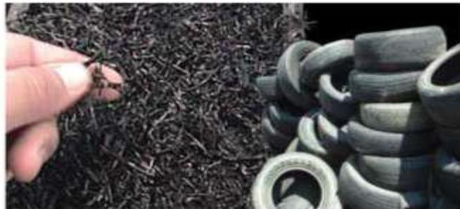
*FIGURA II-30 HULE DE LLANTA TRITURADO*
