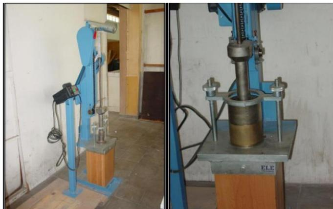
FIGURA II-19 EQUIPO COMPACTADOR Y MUESTRA EN PROCESO DE COMPACTACIÓN.
