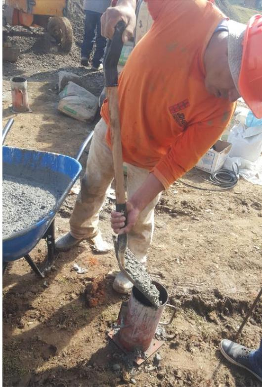
*PROBETAS DE CONCRETO PARA ENSAYO DE RESISTENCIA A LA COMPRESIÓN*
