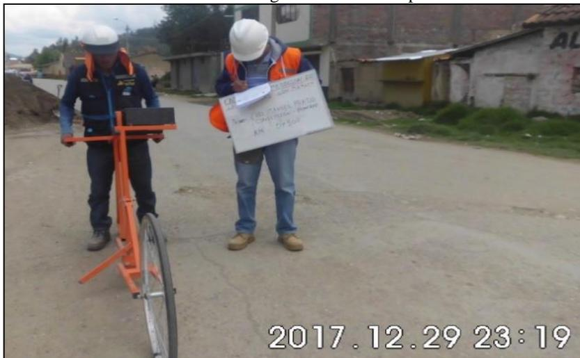
Gráfico N° 27 - medición de la irregularidad de la carpeta asfáltica se realizaron cuatro veces dos de ida y dos de vuelta.
