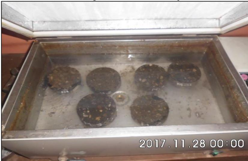
Gráfico N° 21 – pesaje de probeta saturado con agua.
