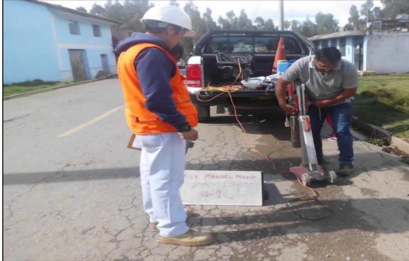
Gráfico N° 8 – en otro tramo para extraer probetas
