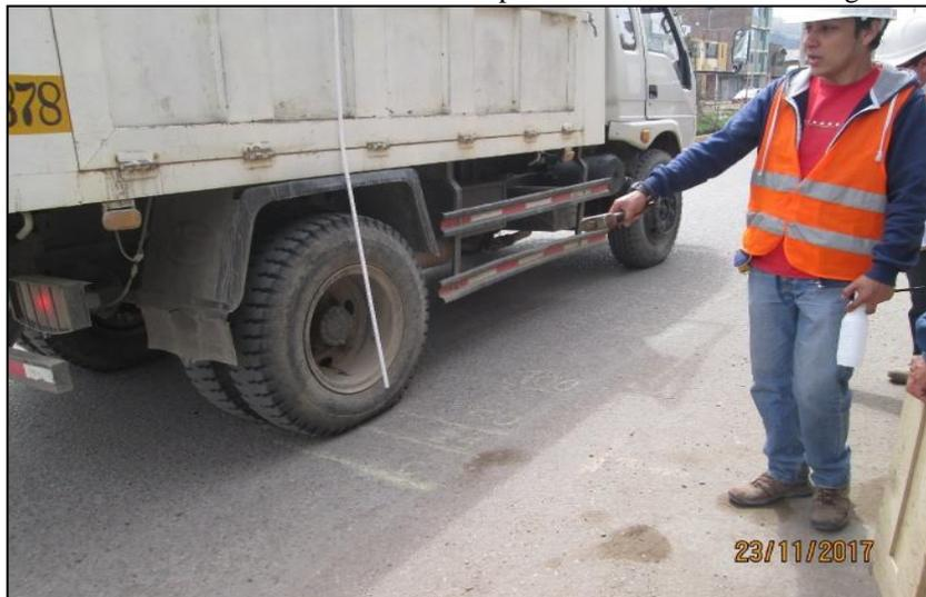
Gráfico N° 15 – posición de la viga Benkelman detrás de la rueda de doble eje.
