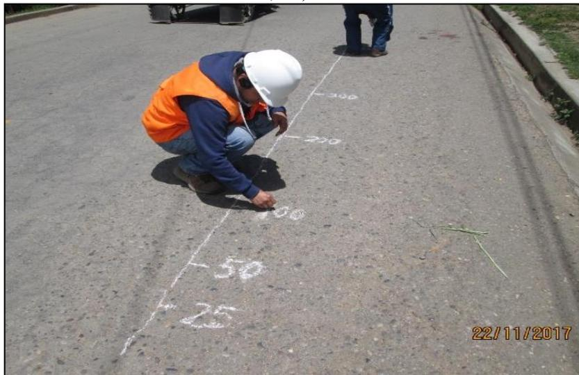
Gráfico N° 14 – alineamiento de ruedas con los puntos de evaluación de la viga Benkelman
