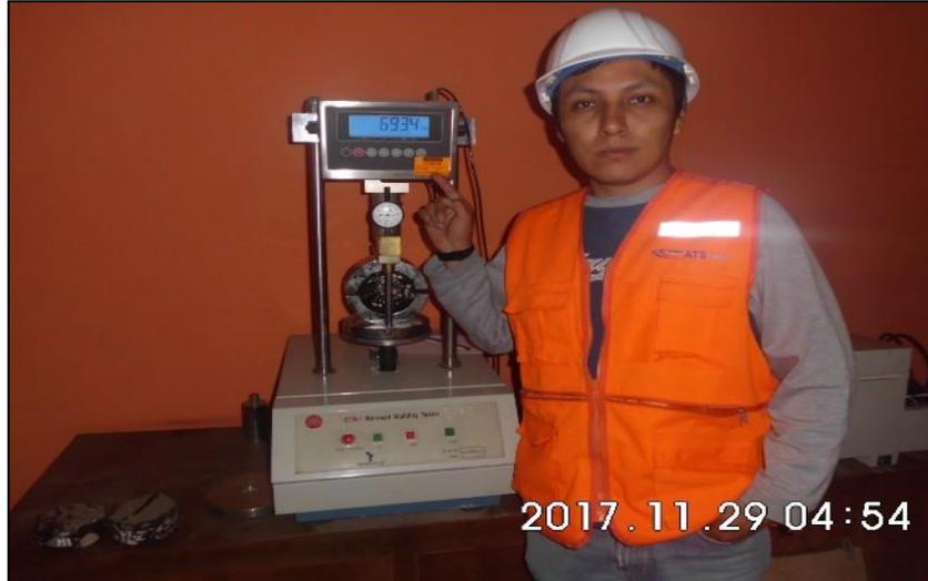
Gráfico N° 23 – se muestra la probeta partida a la mitad por ser sometida a presión de la prensa Marshall
