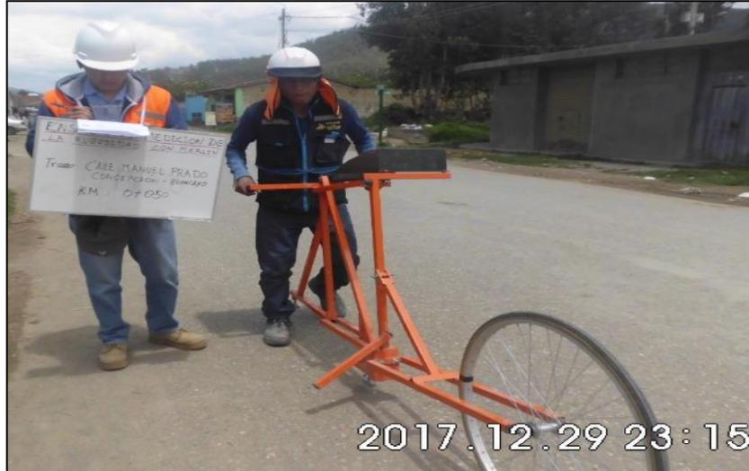
Gráfico N° 26 - medición de la irregularidad de la carpeta asfáltica de vuelta.
