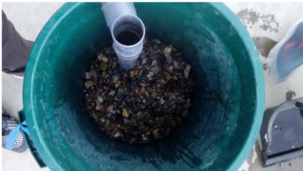
Fotografía 9 y Fotografía 10. Consolidado de cada una de las capas de filtración.
