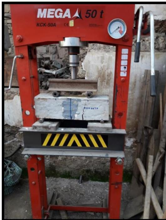
✓ **Aplicación del ensayo ASTM.C78**
