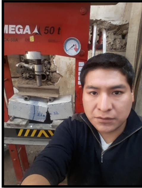
✓ Verificación de resultados Probeta con sikadur 32.
