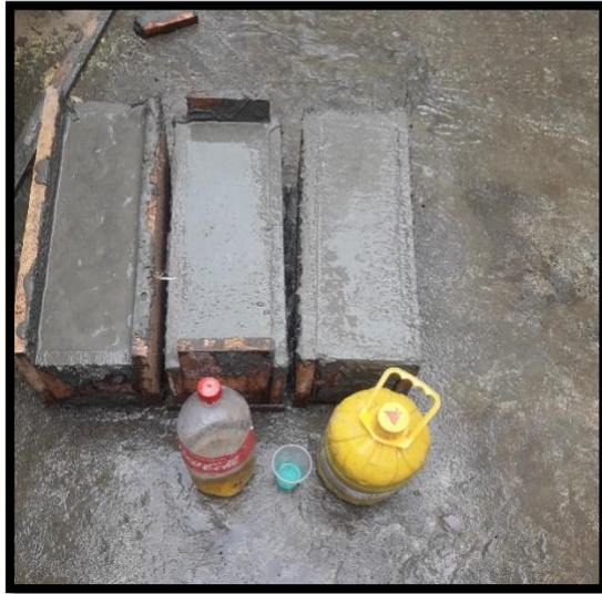
✓ **Baceado de probetas.**
