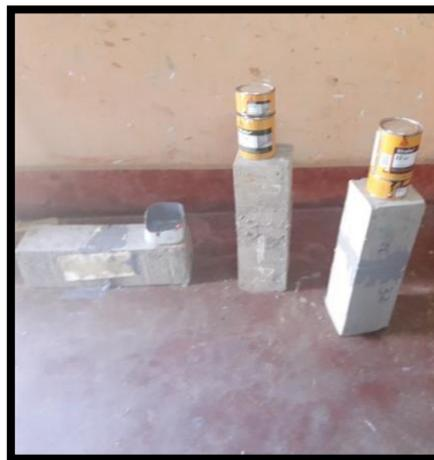
✓ **Probetas listas para secado.**
