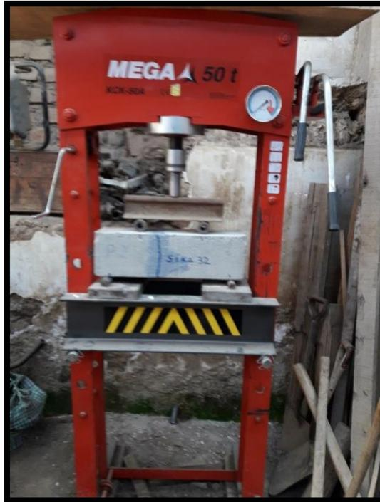
✓ Aplicación del ensayo ASTM.C78 Probeta con sikadur 32.
