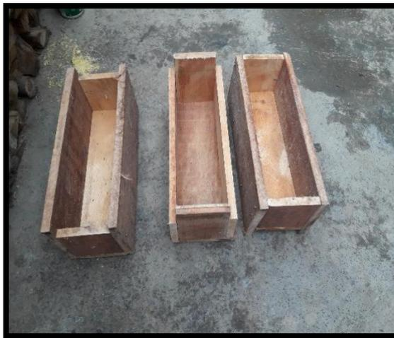
✓ **Encofrado de probetas.**
