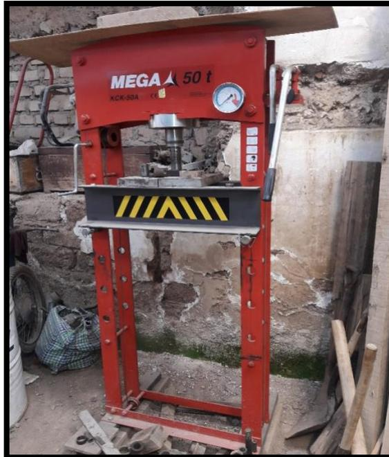
✓ Prensa hidráulica para realizar nuestros ensayos de probetas.
