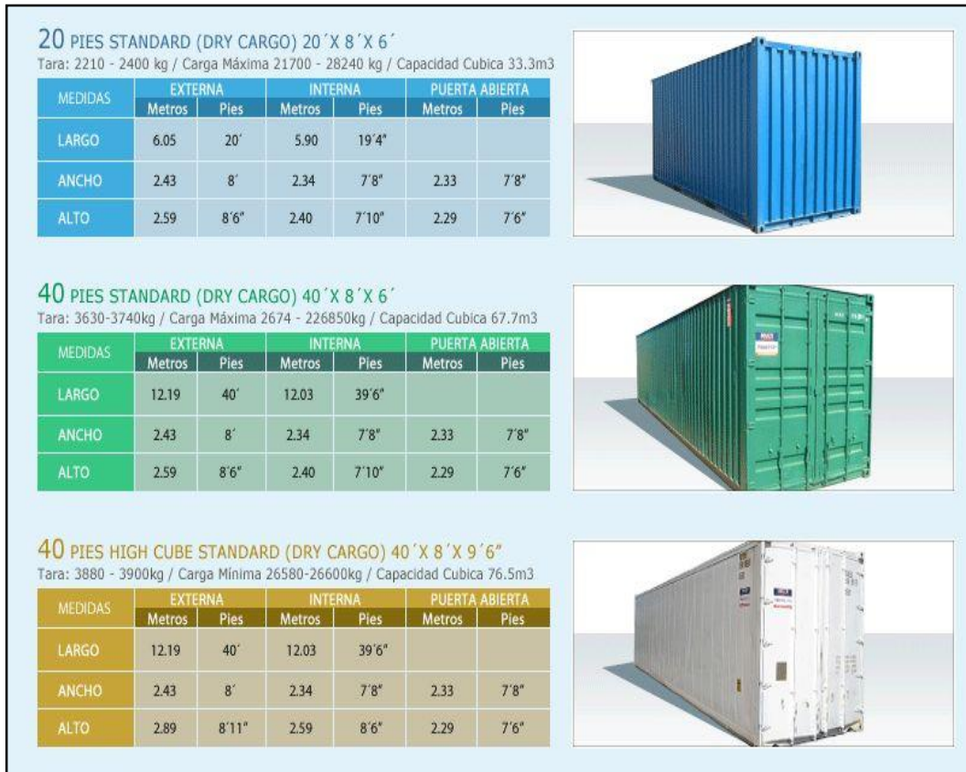
FIGURA N° 33: DIMENSIONES DE CONTENEDOR
