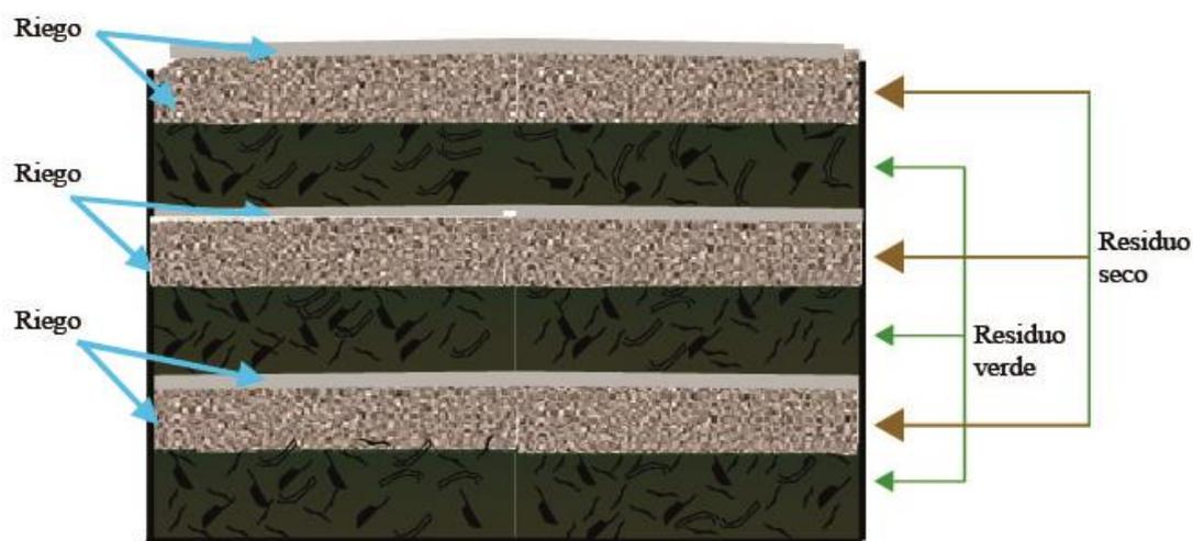
Figura 18. Armado de pila de composta de la planta de producción
