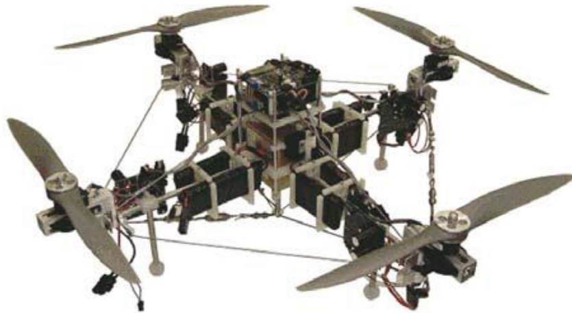
Figura 1.9: Quadrotor diseñado en la Universidad de Cornell
