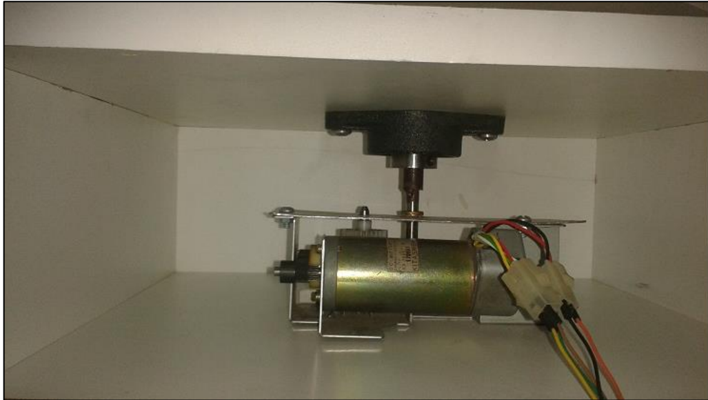
Figura B.2: Sistema reductor de velocidad de la plataforma de calibración
