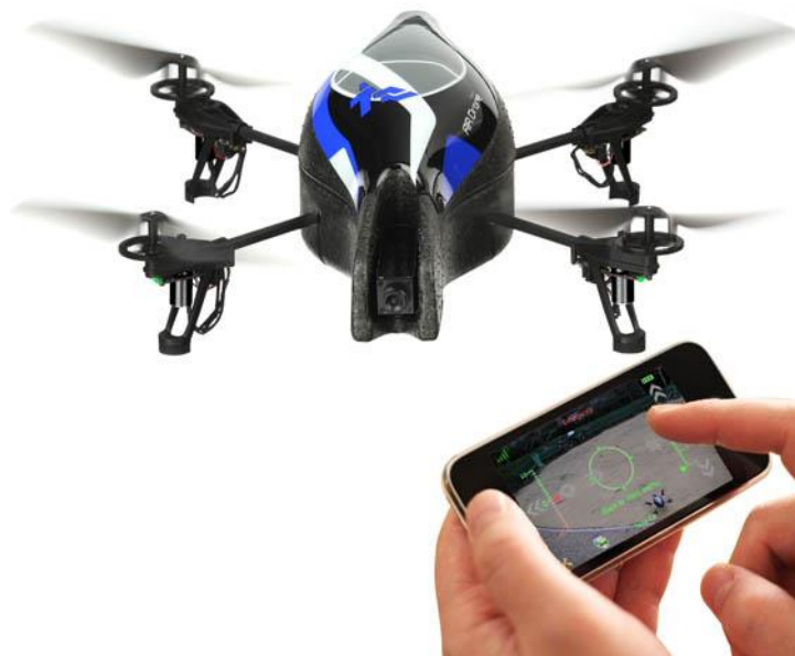
Figura 1.6: Parrot AR.Drone, Quadrotor comercial controlado por un Smartphone
