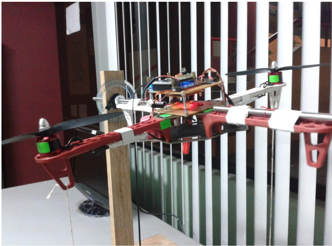
Figura 4.1: Banco de pruebas del Quadrotor
