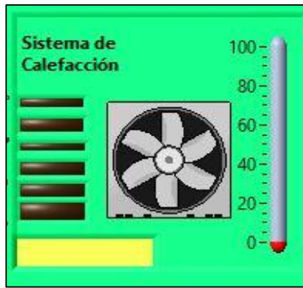
Figura 77. Visualización en el aplicativo del encendido del calefactor y la medición de temperatura del DS18B20 Fuente propia.
