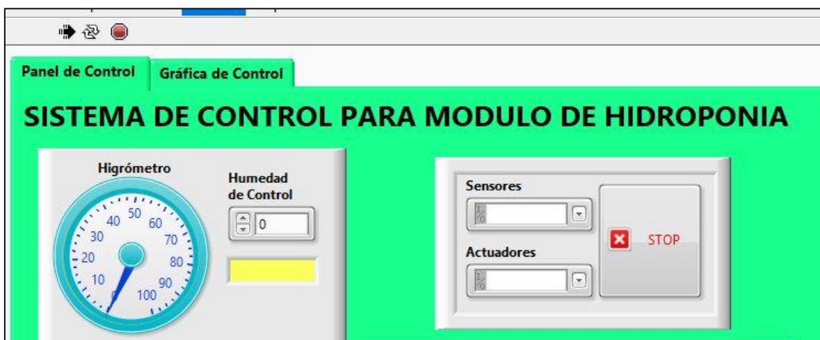
Figura 72. Botones de control de inicio y parada de la ejecución del programa de control. Fuente propia.
