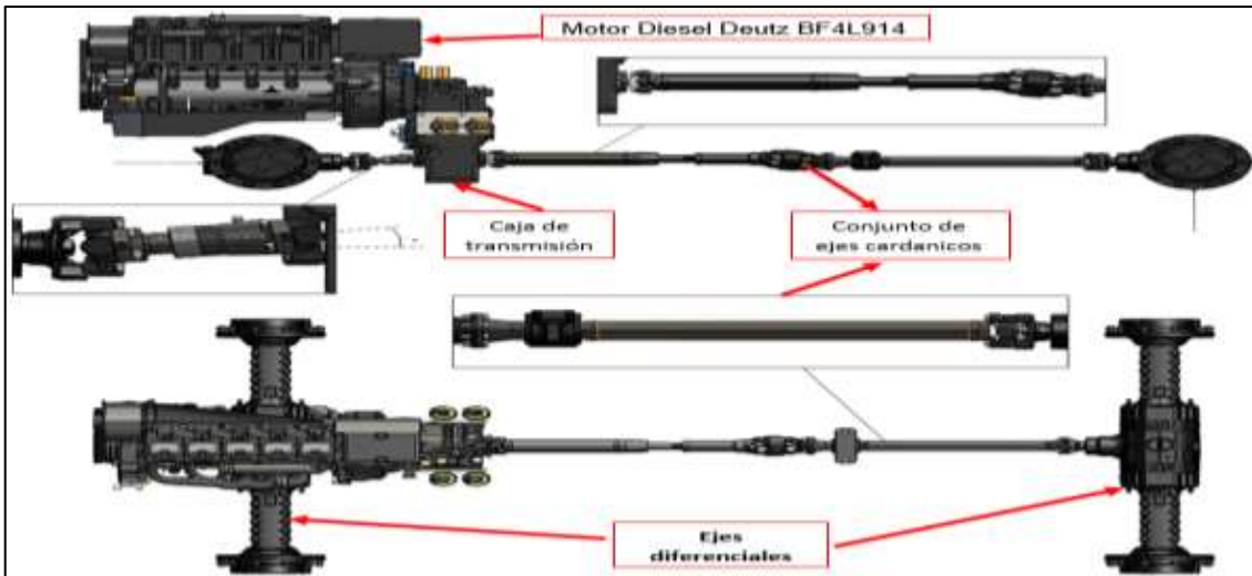
Fig. 47. Motor Diesel Deutz BF4L914, caja de transmisión, ejes diferenciales y conjunto de ejes cardanicos [21]
