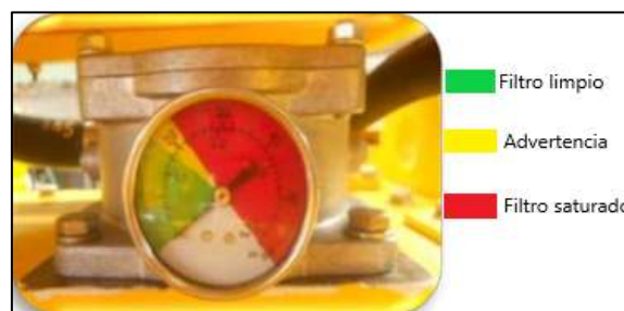
Fig. 77. Reloj de saturación (ajuste y lubricación) [21]
