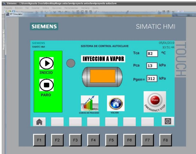
Figura 124: Panel condicionamiento del proceso de esterilización “INYECCION”.
