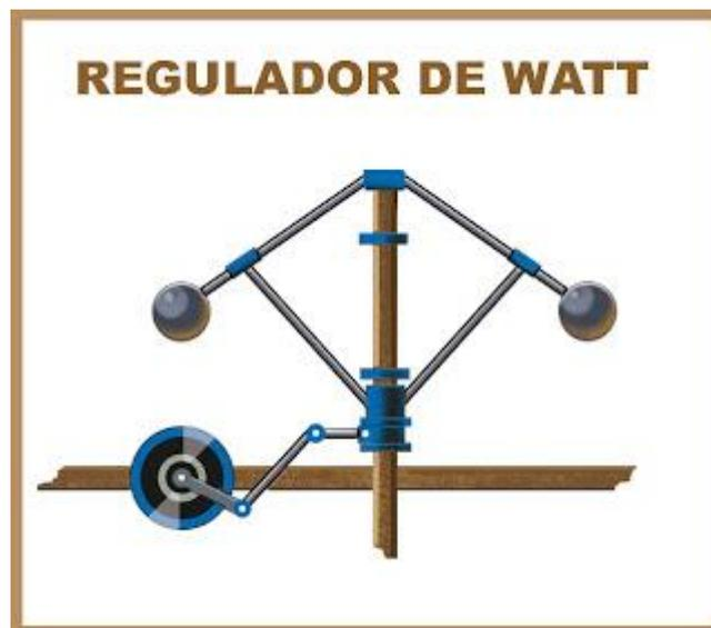
*Figura 3: Regulador de velocidad centrífugo de James Watt.*
