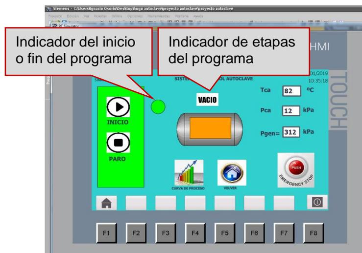
Figura 58: Panel Inicio del proceso de esterilización "VACÍO".
