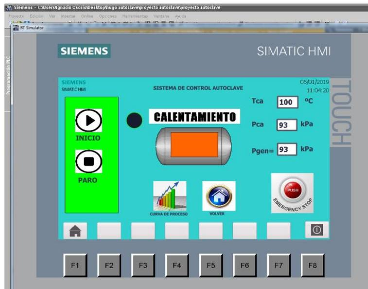
Figura 126: Panel de “CALENTAMIENTO” del proceso de esterilización.
