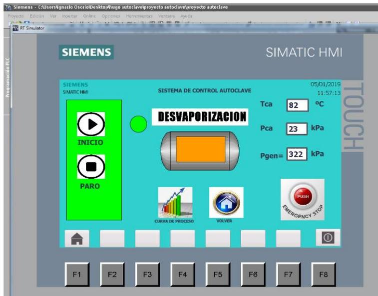
Figura 129: Panel de “DESVAPORIZACION” del proceso de esterilización.
