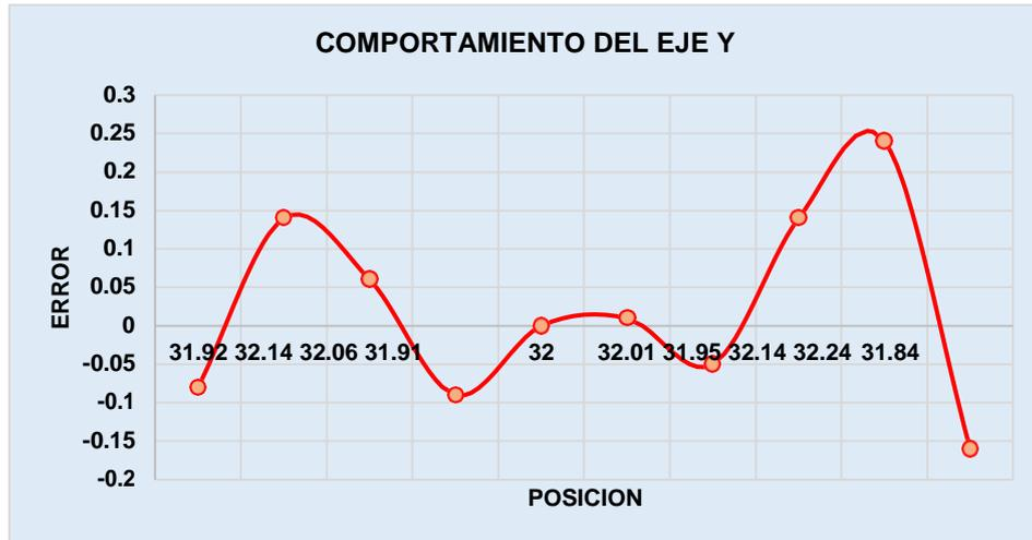
Figura 42. Error del posicionamiento del eje Y
