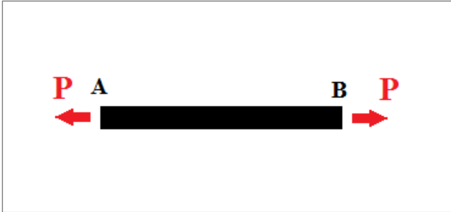
Figura N° 2. 19: Varilla sometida a esfuerzo normal. (Elaboración propia, 2 017)
