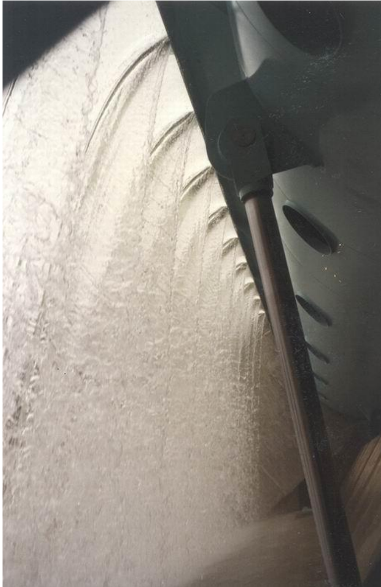
Figura 4.22. Napa vertiente dividida por los divisores de flujo de agua [1].
