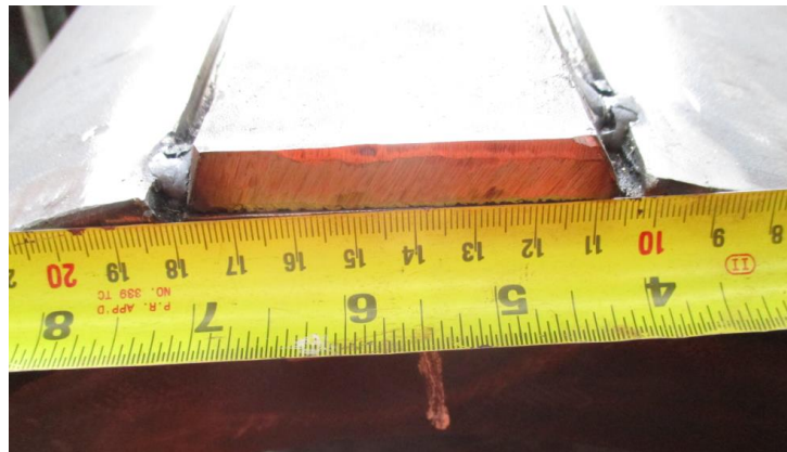
Ranura presenta un ancho de 80mm por 2 a 2.5mm de profundidad
