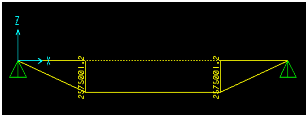
Figura 5.41. Diagrama de momento flector en el pin de izaje.
