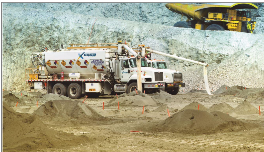
Figura 10: Carguío de Taladros
