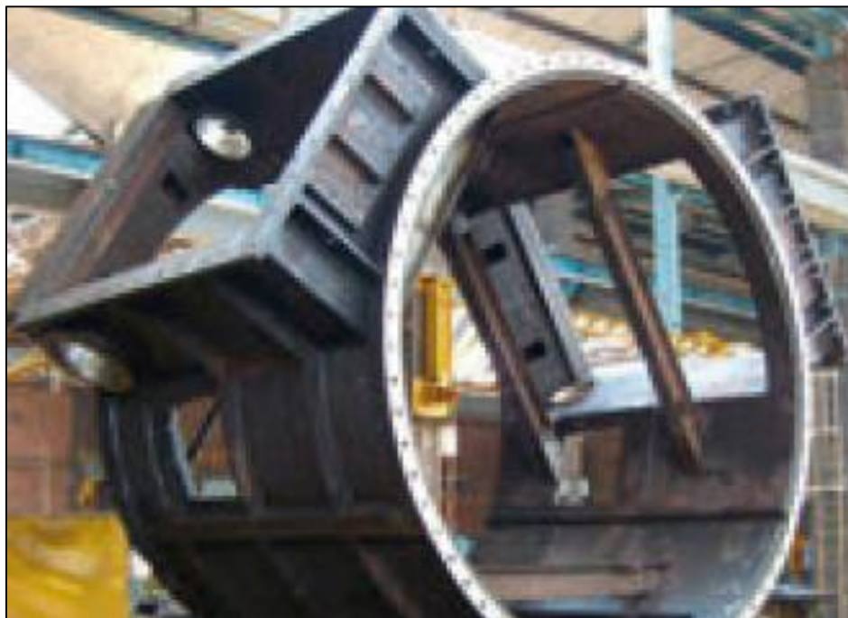
Figura N° 44 Cascada de Turbina.
