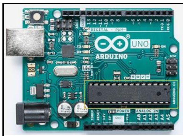
Figura 30: Plataforma electrónica Arduino UNO con microcontrolador ATMEGA328 removible [32].
