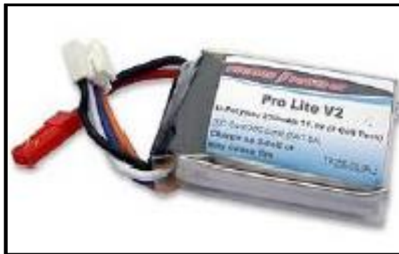
Figura 25: Batería de polímero de litio (Li-Po) [8].
