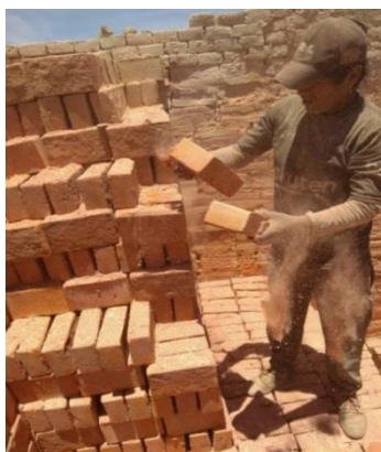
Imagen 02: Descarga del ladrillo cocido
