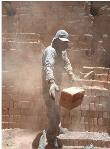
Imagen 04: Descarga del ladrillo cocido
