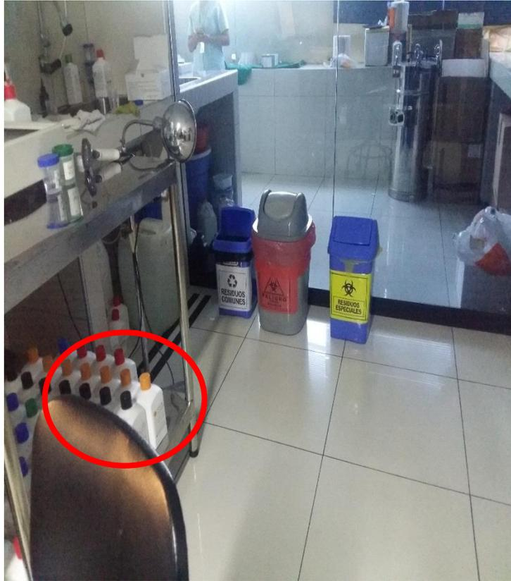
Ilustración 4: Se observa sustancias peligrosas, reactivos, dentro del área de observación, no estando en el lugar correspondiente (almacén)
