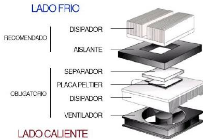
Figura 7. Partes de un módulo Peltier. Fuente: [16]
