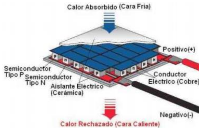
Figura 5. Partes de una celda Peltier. Fuente: [15]
