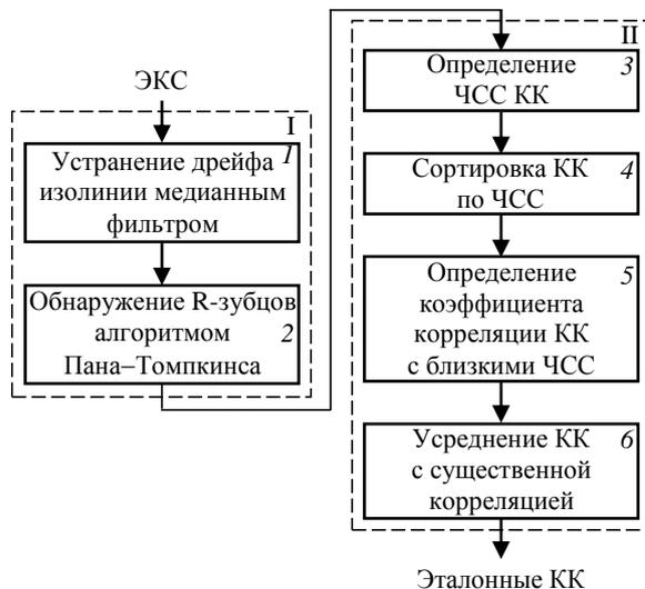
Рис. 2. Структурная схема алгоритма сортировки КК
