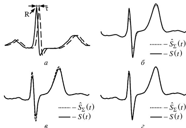
Рис. 4. Влияние ошибок синхронизации на форму эталонного КК:  $a$  – отклонение оценки точки синхронизации;  $b$  – ошибка усреднения, вызванная неточной синхронизацией;  $c$  – результат коррекции формы накопленного сигнала согласно (2);  $z$  – результат коррекции согласно (3)
