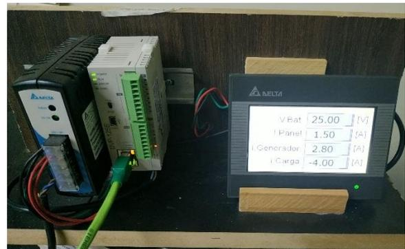
Fig. 4. PLC DELTA y HMI DELTA utilizados en la implementación.
