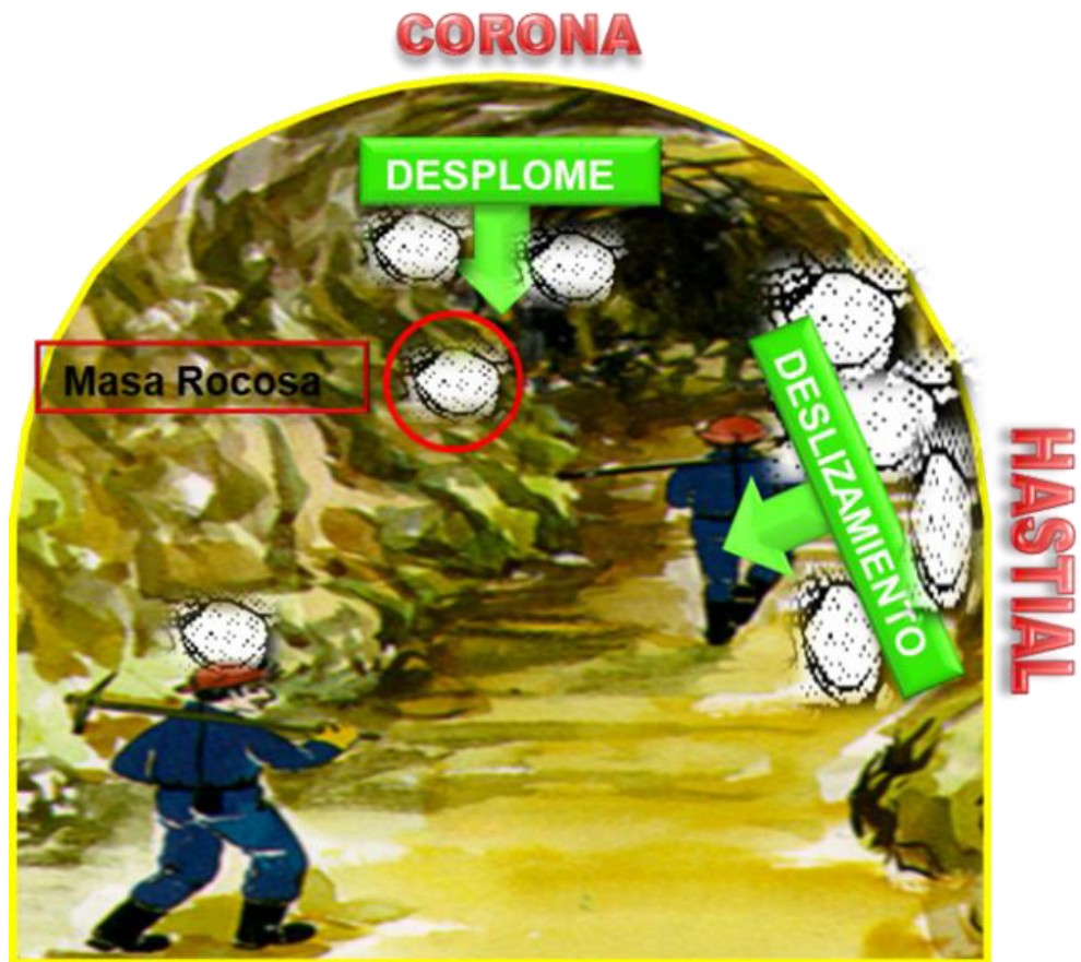
Figura N°22. Desprendimiento de rocas Fuente: Libro Control de Pérdidas II
