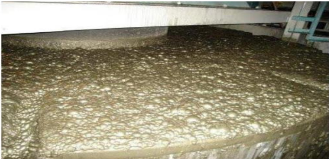
Figura 12. Flotación de sulfuro de cobre
