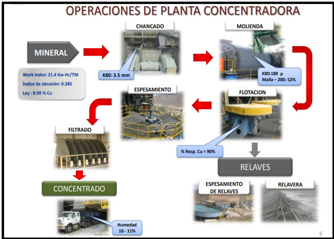
Figura 11. Operaciones de planta concentradora Tomado del II Encuentro Internacional Metalurgia CIA minera Condestable
