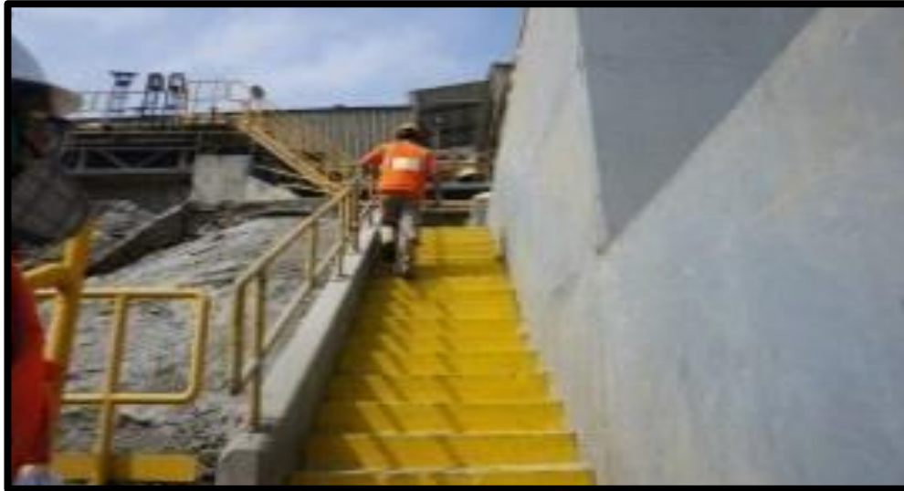
Figura 28. E trabajador está bajando utilizando los tres puntos de apoyo
