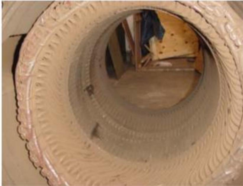
Figura 16 Bobinado del estator contaminado
