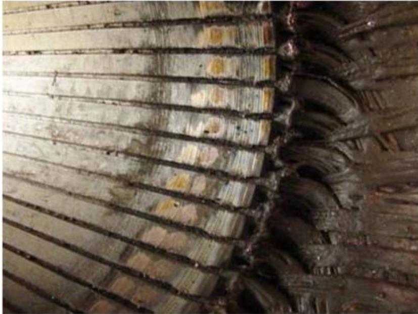
Figura 20 Falla por efecto del rozamiento entre rotor y estator
