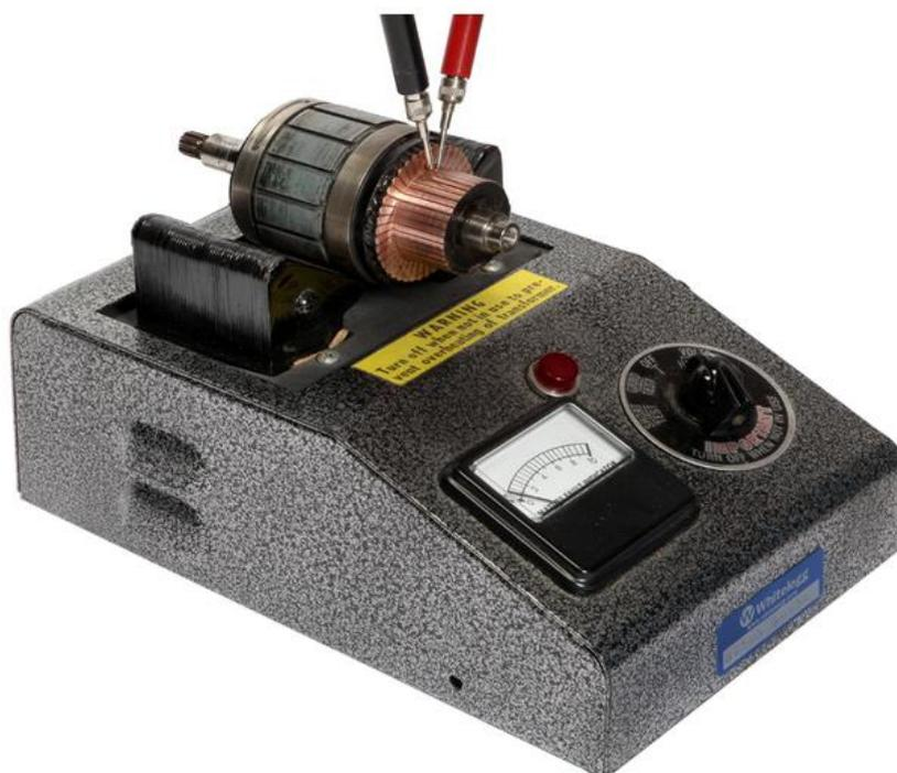
Figura 18 prueba de rotor con growler
