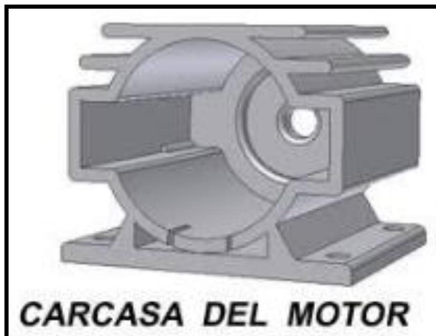
Figura 14 Carcasa de Motor
