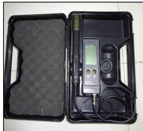
Fotografía 8: Potenciómetro de suelo utilizado para la lectura del pH y conductividad eléctrica
