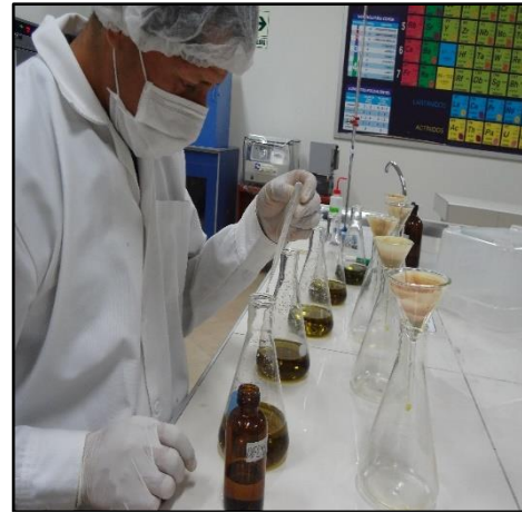
Fotografía 10: Determinación del carbono orgánico por el método Walkley-Black
