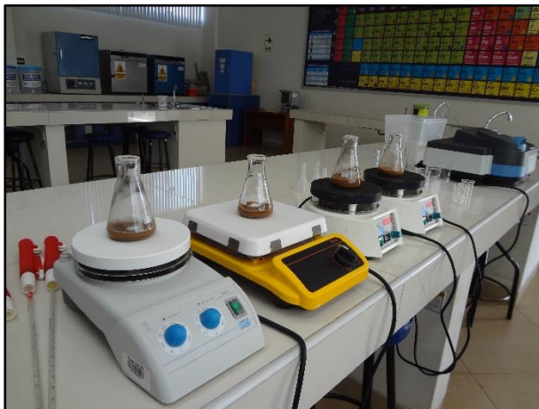
Fotografía 11: Agitadores magnéticos usados para la mezcla automática
