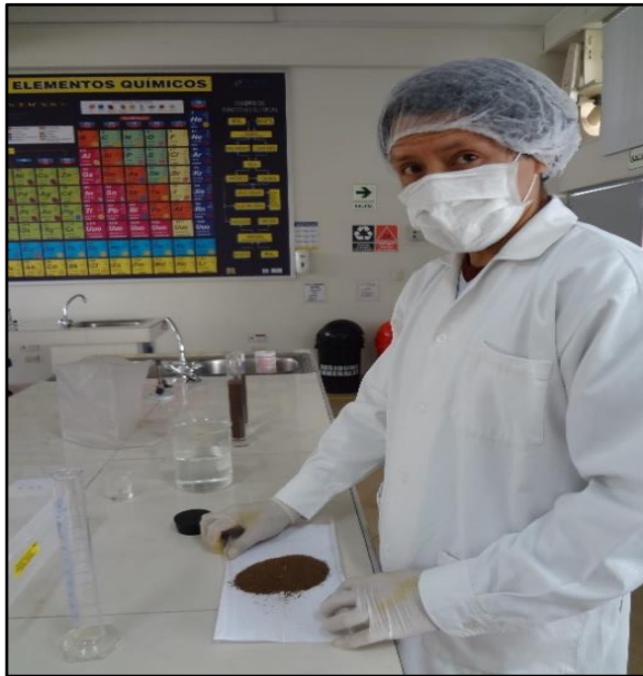
Fotografía 5: Determinación de la densidad y porosidad por el método de la probeta
