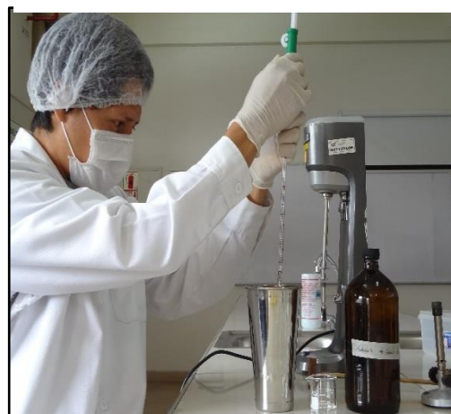
Fotografía 4: Determinación de la textura por el método de Bouyoucos
