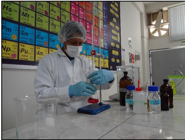
Fotografía 9: Titulación con versenato como parte de la determinación de la capacidad de intercambio catiónico
