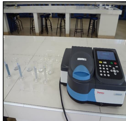
Fotografía 12: Espectrofotómetro usado dentro del proceso de determinación de fósforo y potasio
