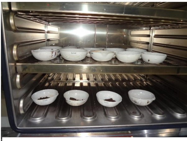
Fotografía 7: Secado de muestra a 105° en el horno de secado
