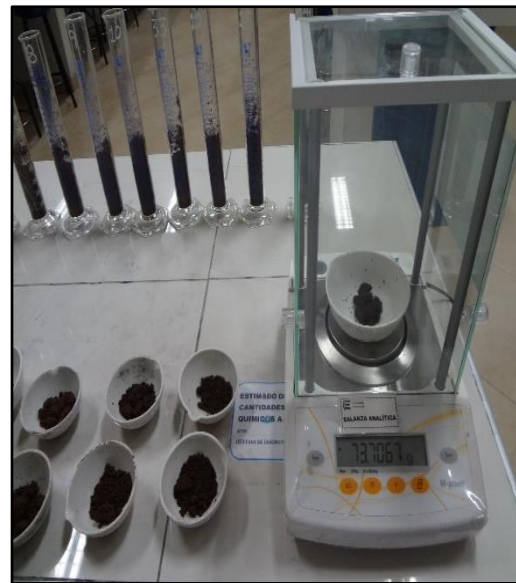
Fotografía 6: Determinación de la capacidad de campo del suelo de forma gravimétrica
