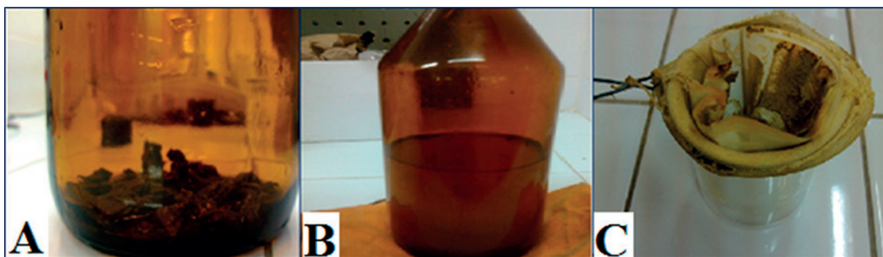
Figura 2. Elaboración del extracto etanólico de propóleo. A. Trozado del propóleo crudo. B. Macerado. C. Filtrado
